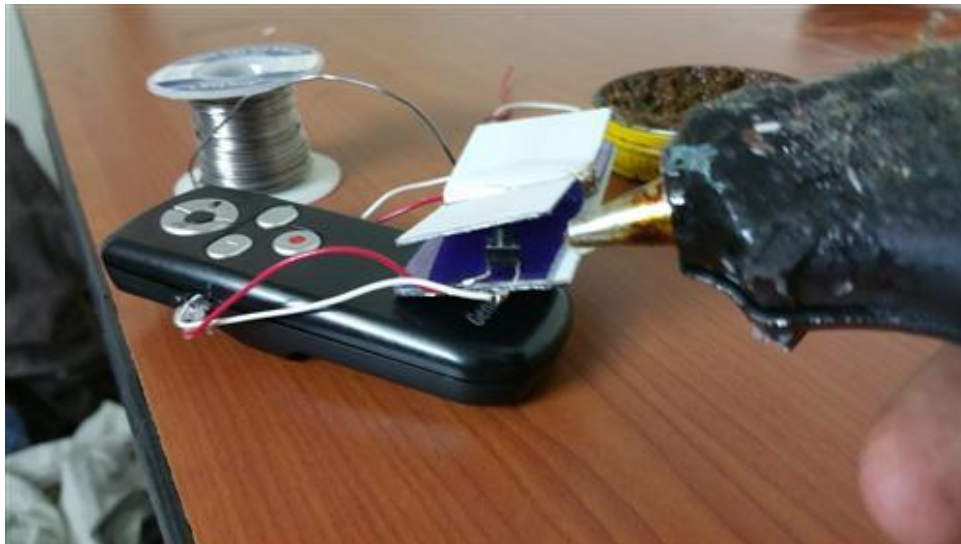
Se pega esta placa con los dos microrruptores sobre el mando.
