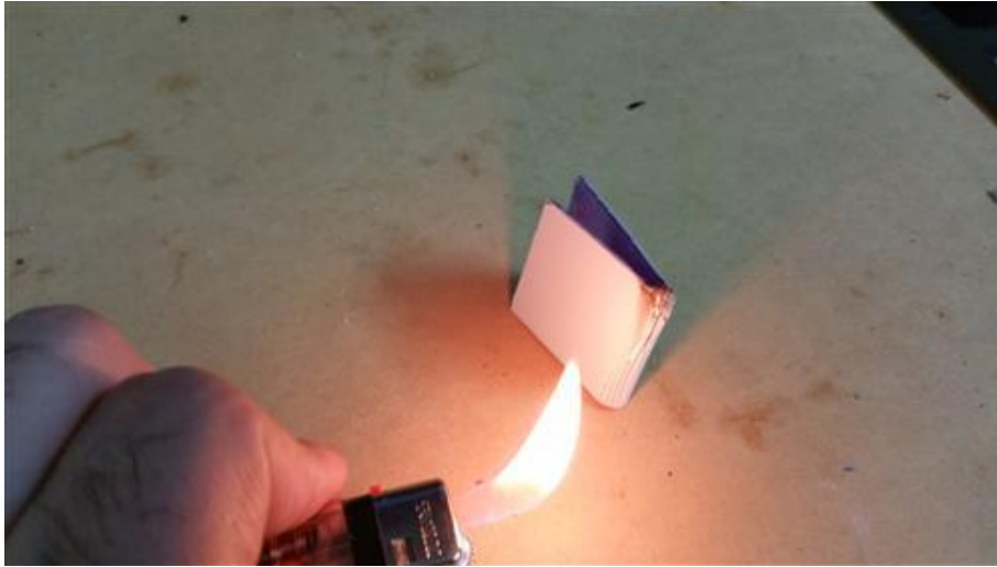
Doblado de la placa de plástico.
