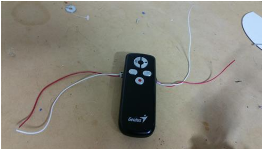
Mando cerrado con los cables del microrruptor fuera de él.
