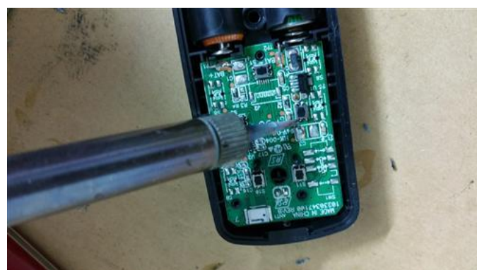
Desoldado de los microrruptores.
