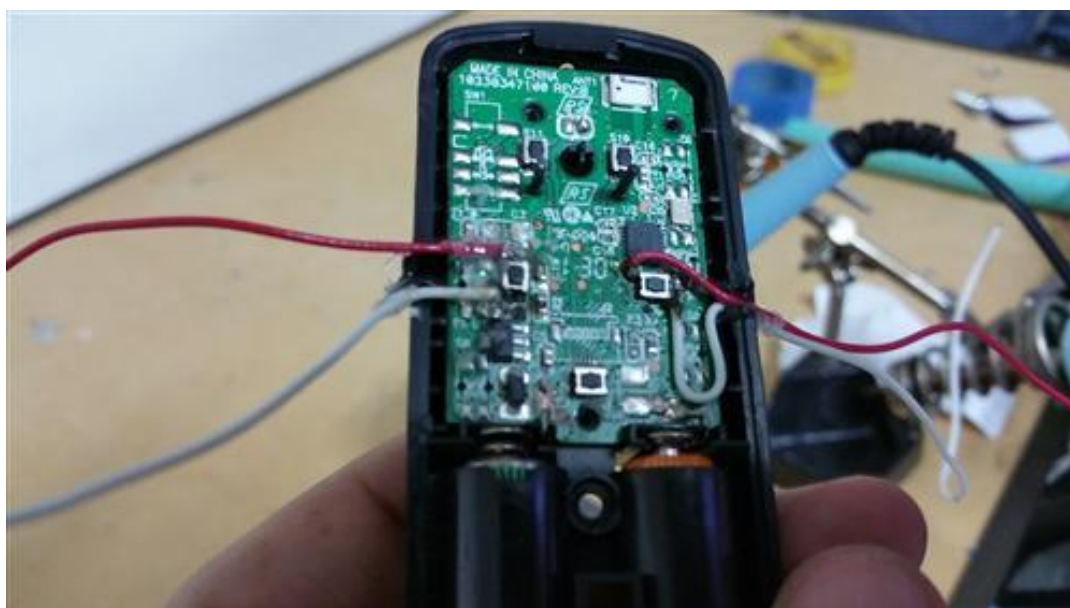
Soldado de los cables a los microrruptores.
